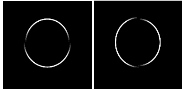
Bild 2 Frontale Ansicht eines ovalen Objektes senkrecht (links; 0^\circ ) und waagrecht (rechts; 90^\circ ) ausgeleuchtet. Der weiße Vordergrund entspricht dem Schattenwurf in der Riefe.
