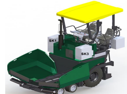
Diesel-Elektrischer Antrieb 2012 - Radfertiger
